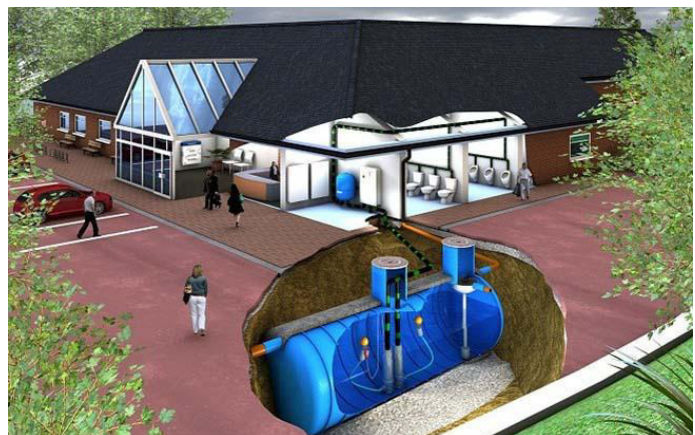
Figura 12. Schemi funzionali dell'impianto di recupero e reimpiego acque meteoriche.
