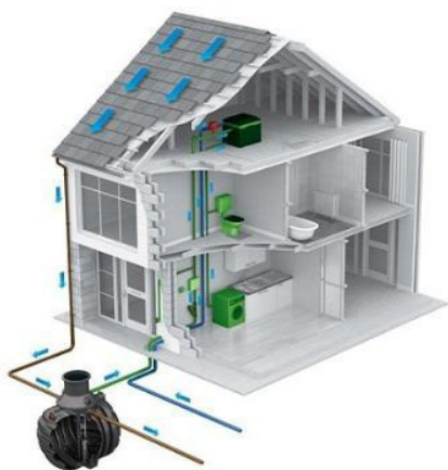
Figura 12. Schemi funzionali dell'impianto di recupero e reimpiego acque meteoriche.
