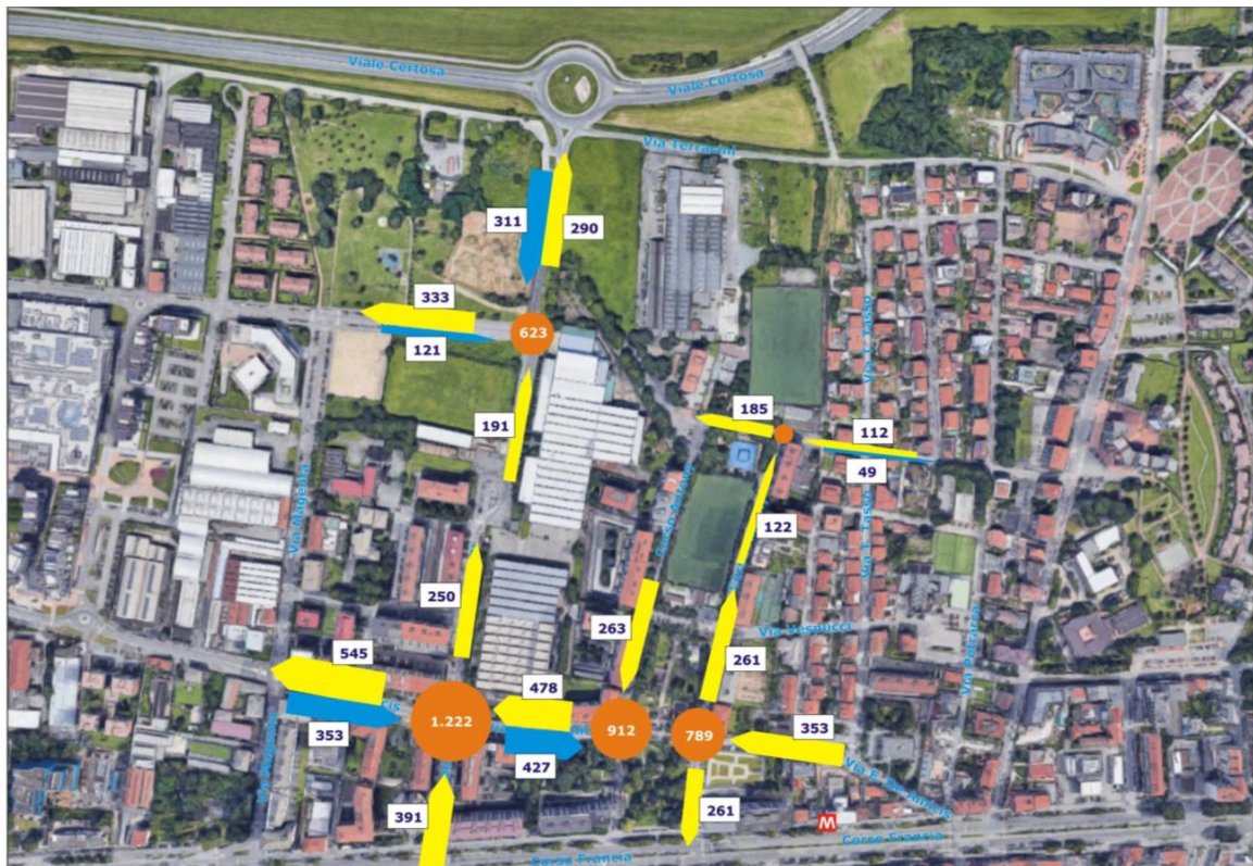
Tavola 14 – Attuali flussi di traffico sulla viabilità di diretta refrenza degli interventi edilizi, punta pomeriggio 18:00-19:00, veh/h [Fonte: elaborazioni consulenti]
