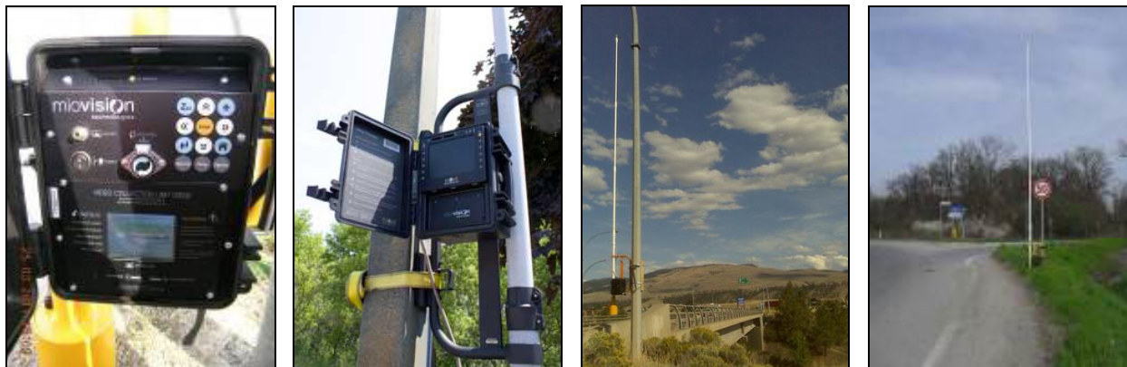
Figura 16 – Esempi di posizionamento del Sistema Portatile di Analisi Video
