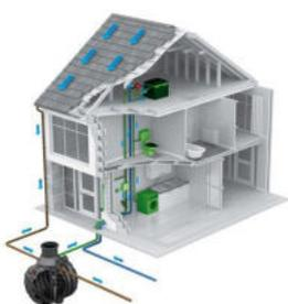
Esempi e schemi di Impianto di raccolta, recupero e riutilizzo dell'acqua piovana mediante l'impiego di vasche di raccolta
