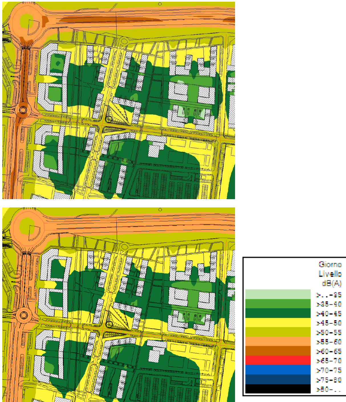
Figura 9.2.3.III - Mappe acustiche a 4 metri dal suolo (mappa superiore) e a 7 metri dal suolo (mappa inferiore) nel periodo notturno e con asfalto fonoassorbente
