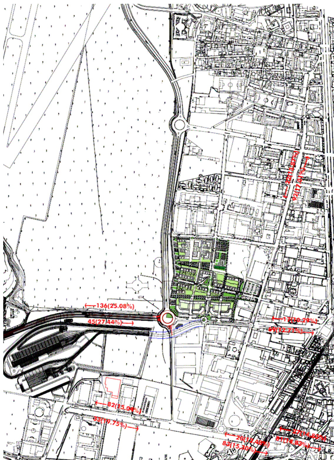
Figura 8.1.3.5III – Distribuzione del traffico indotto sulla rete stradale circostante l'area del Progetto di Massima misurati nell'intervallo critico
