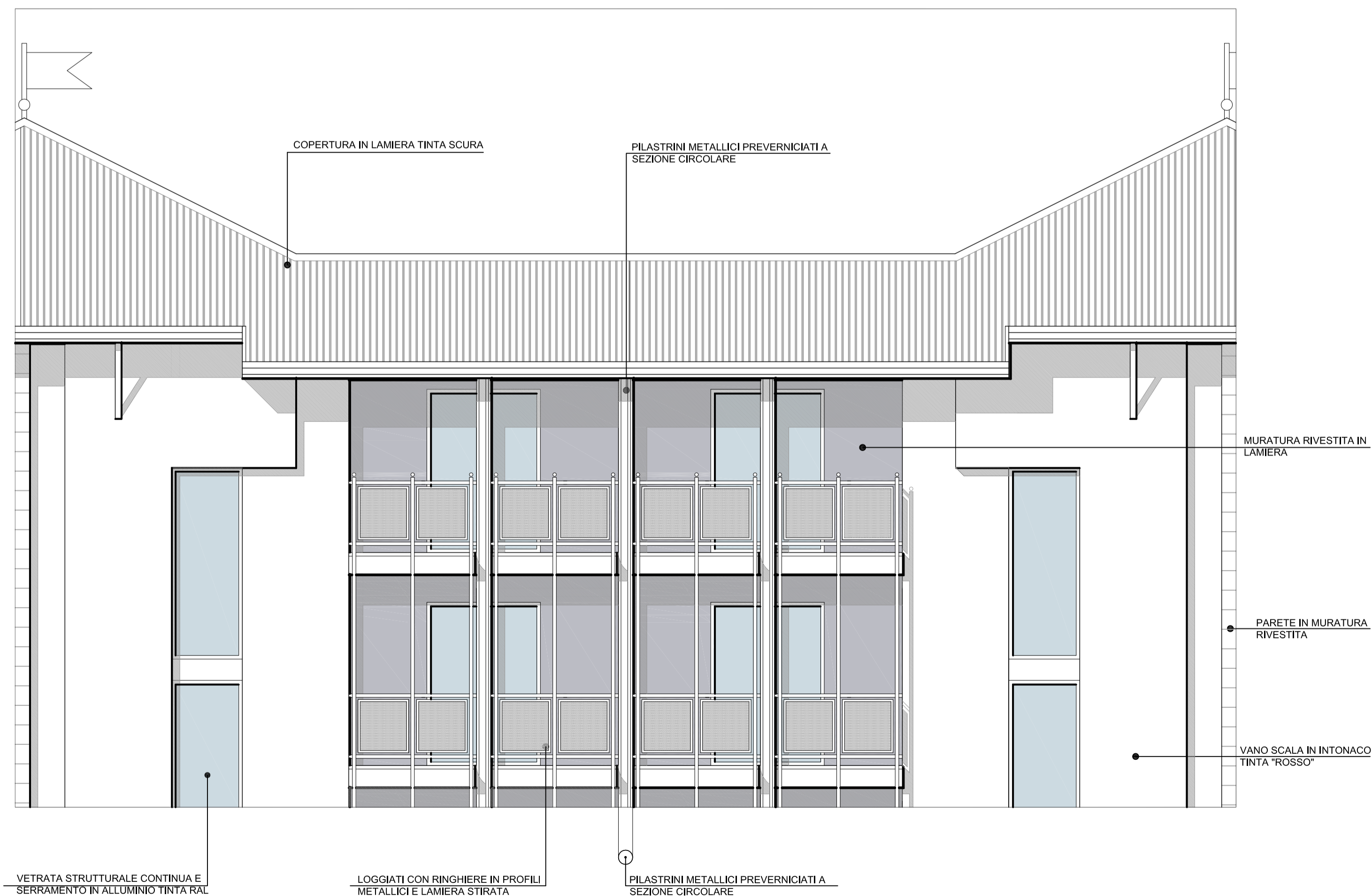
DETTAGLIO 1 LOGGIATI E VANO SCALA - SCALA 1:50
