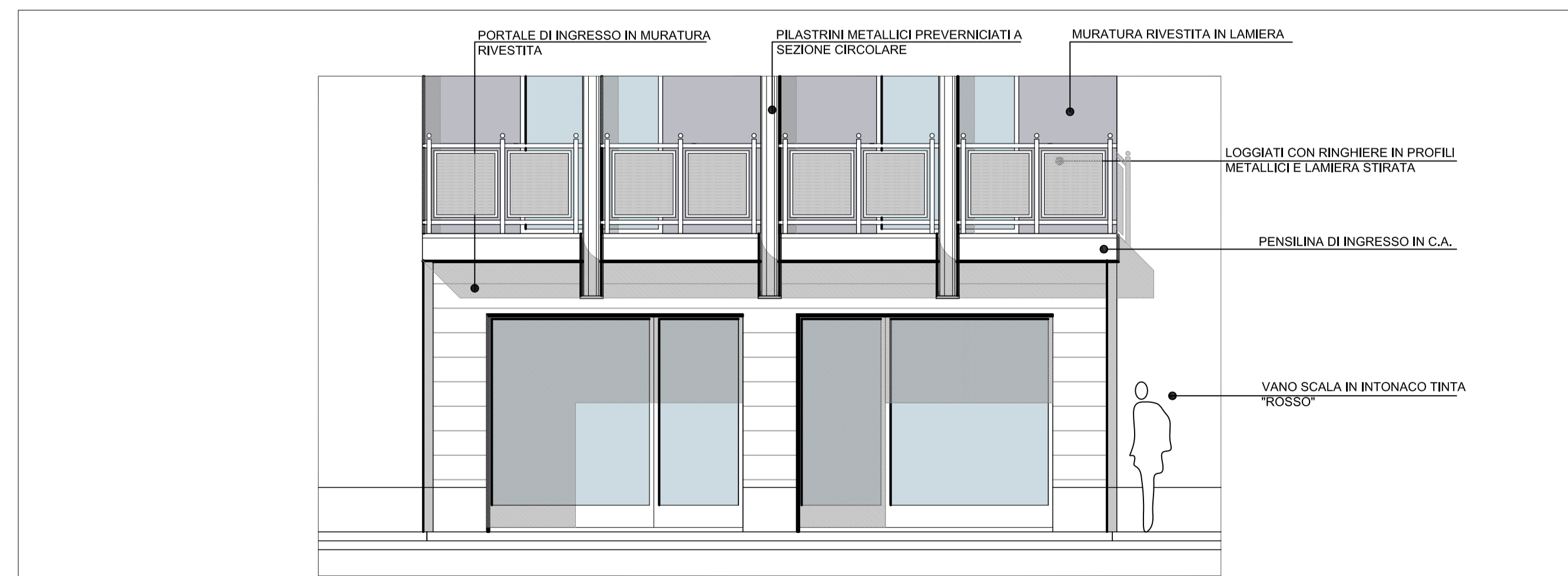
DETTAGLIO 2 PORTALE DI INGRESSO - SCALA 1:50
