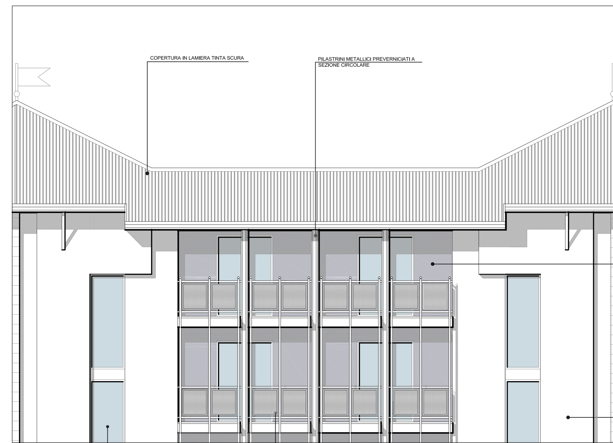
DETAGLIO 2 LOGGIATI E VANI SCALA - SCALA 1:50
