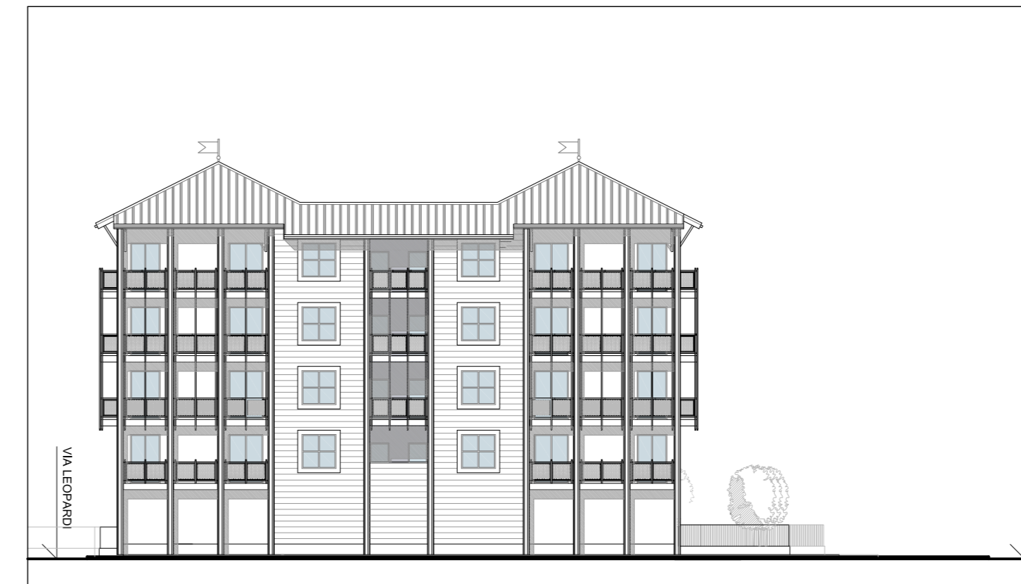
SCHEMA PROSPETTO LATO CORTILE - SCALA 1:200
